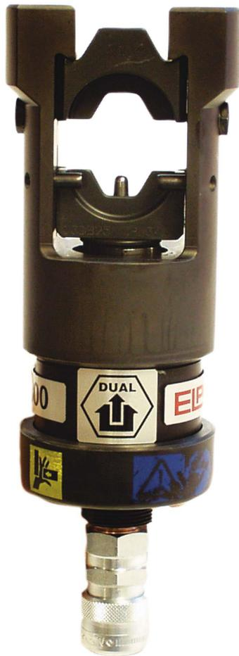
Presskopf zum Crimpen von Cu-Verbindern det Type KRF/KSF 10-400 mm<sup>2</sup>. DV1300 wird zusammen mit Fußpumpe P4000 oder El-Hydr. Pumpe PS710 verwendet.
